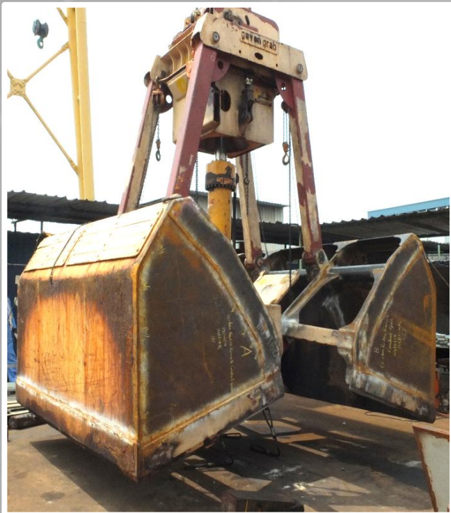
荷役用グラブバケットの修理
