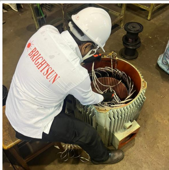
電動モーターコイルの巻き 替え
