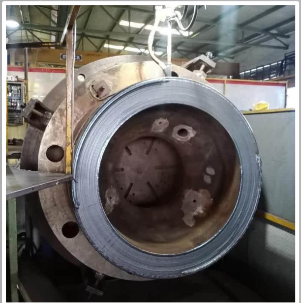
자동 서브머지드 아크(SAW) 용접 - 실린더 커버
