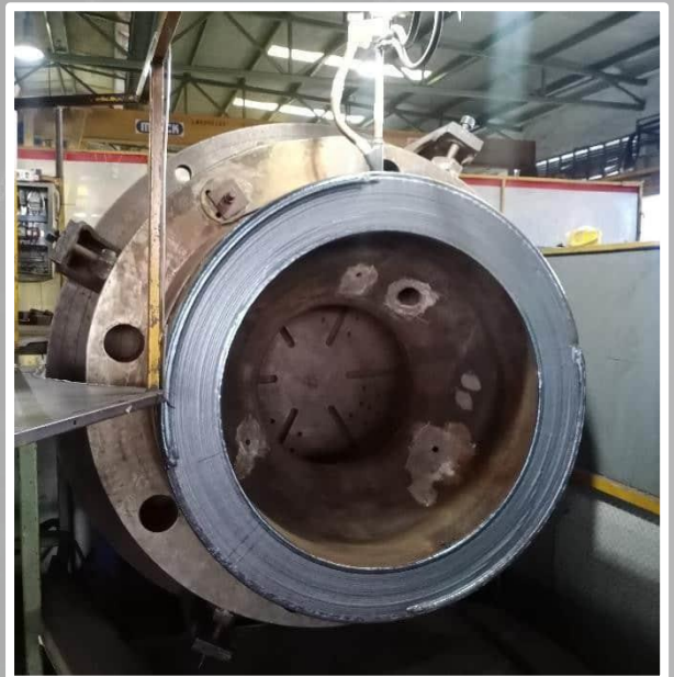
자동 서브머지드 아크 (SAW) 용접 - 실린더 커버
