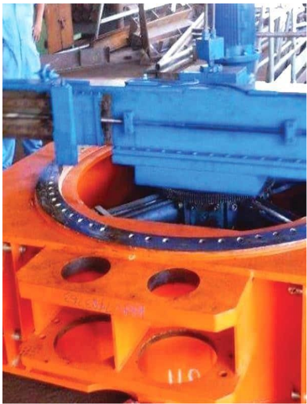
현장 크레인 받침대 플랜지 가공
