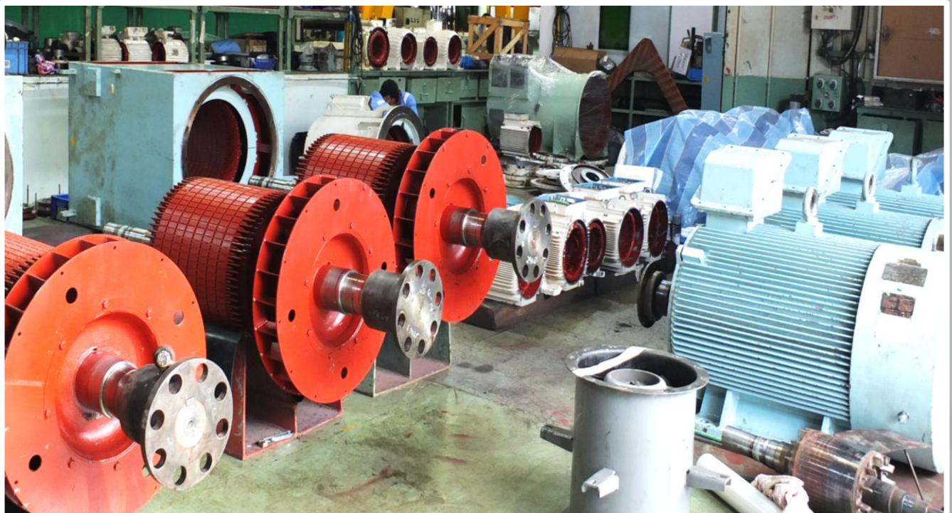
電動モーター開放点検
