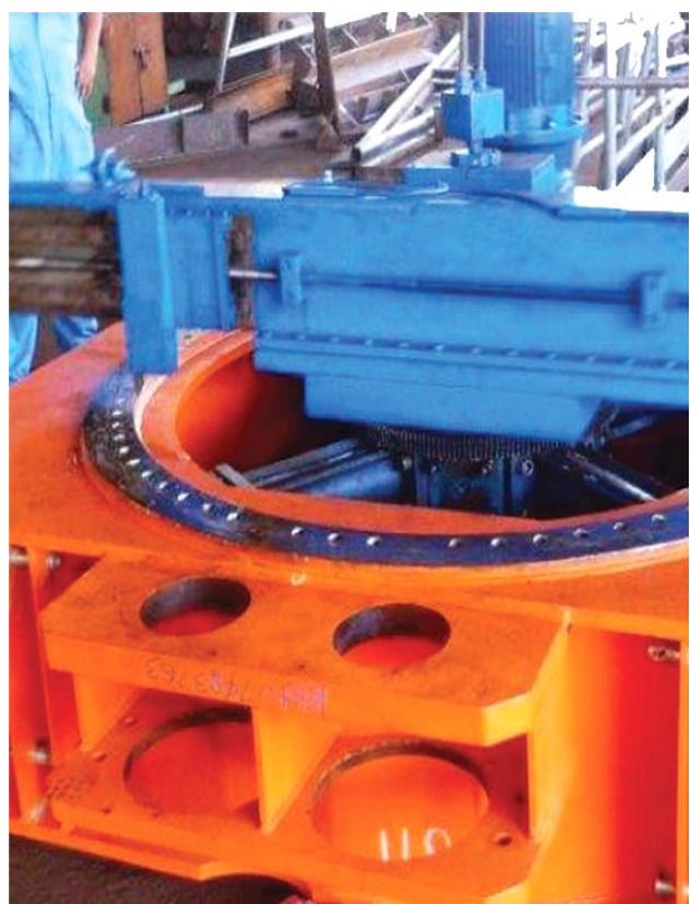
クレーン台座フランジ表面加工
