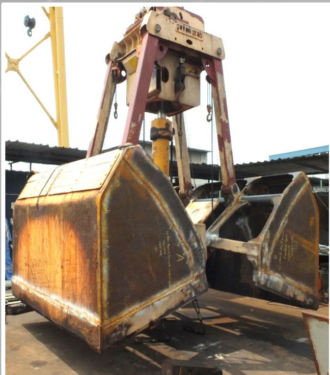
荷役用グラブバケットの修理
