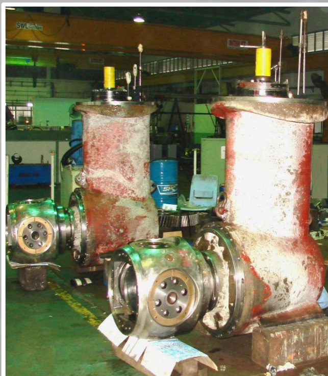
スラスターのオーバーホール
