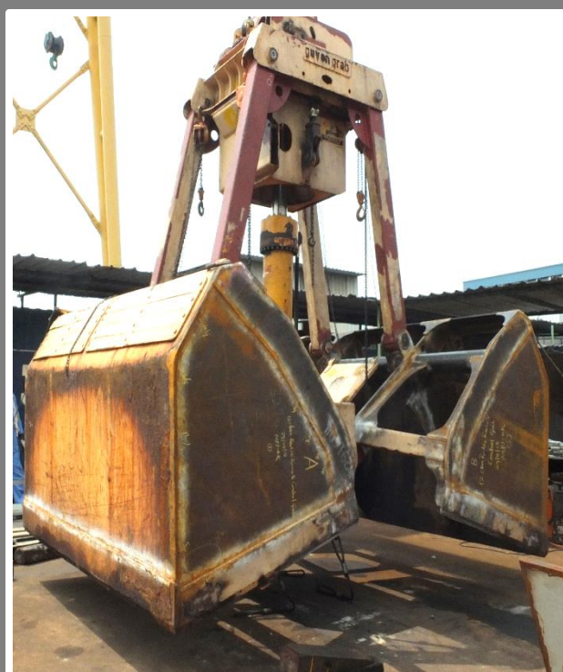
荷役用グラブバケットの修理
