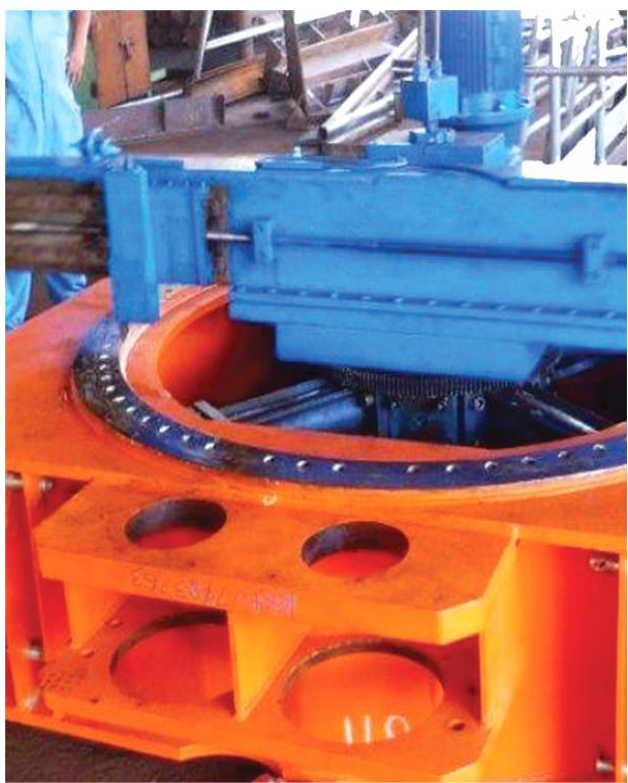
クレーン台座フランジ表面加工
