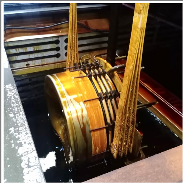
ピストンリング溝 硬質クロムメッキ加工
